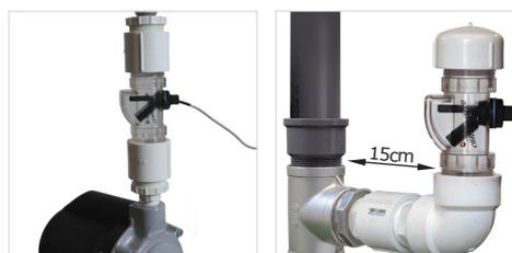
**Funcionamiento** Montaje directo en bombas hasta 1CV (1 HP) o indirecto (derivación), cerrando el contacto eléctrico (reed switch) cuando el agua alcanza el nivel del sensor interno.
